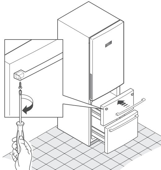
Для того, чтобы облегчить процесс чистки, вы можете извлечь из холодильника внутренние части. Следуйте инструкции, изображенной на картинке:
